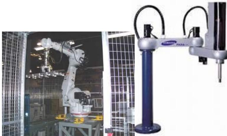
**Figure II.13 :** Bras manipulateurs de type anthropomorphe et SCARA
