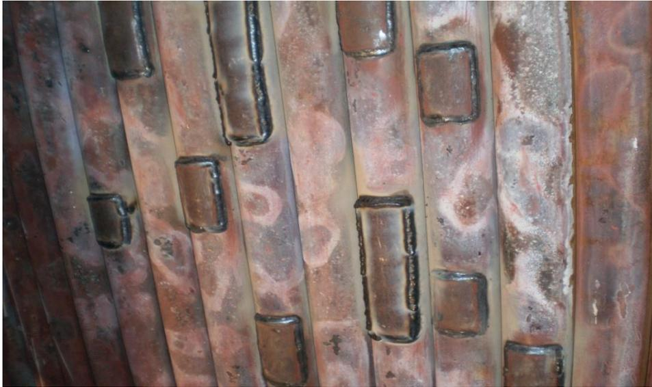
**Figure IV.3 : Des trous d'eau sur les écrans de face qui sont soudé**
