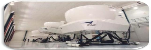
Figure 1:30 Simulateur de vol CAE
