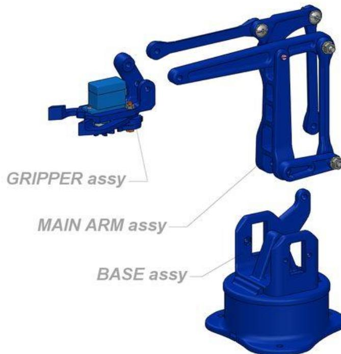
Figure 4:25 Étape 13 : Assemblage final.
