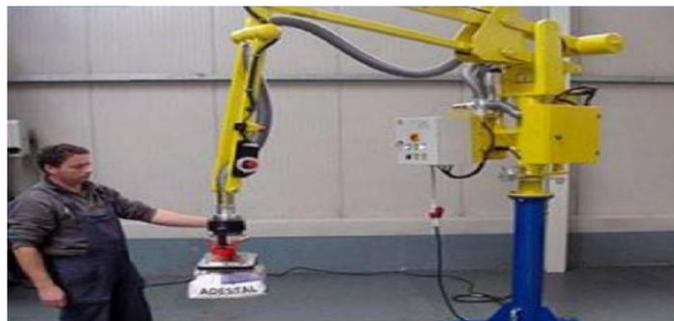
Figure 1:49 Manipulateur à commande manuelle
