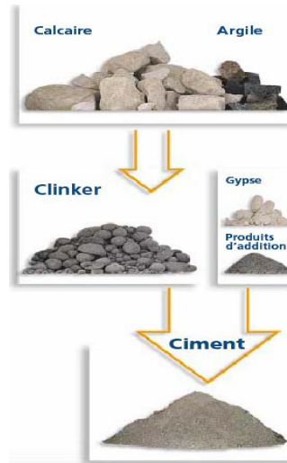
Figure 1.2 : Résumé du processus de fabrication du ciment [18]
