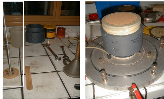
Figure III.17: Dame de compactage et échantillon arasé après compactage.
