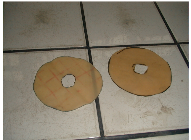
Figure III.13: Membrane en latex et système d'antifretage.
