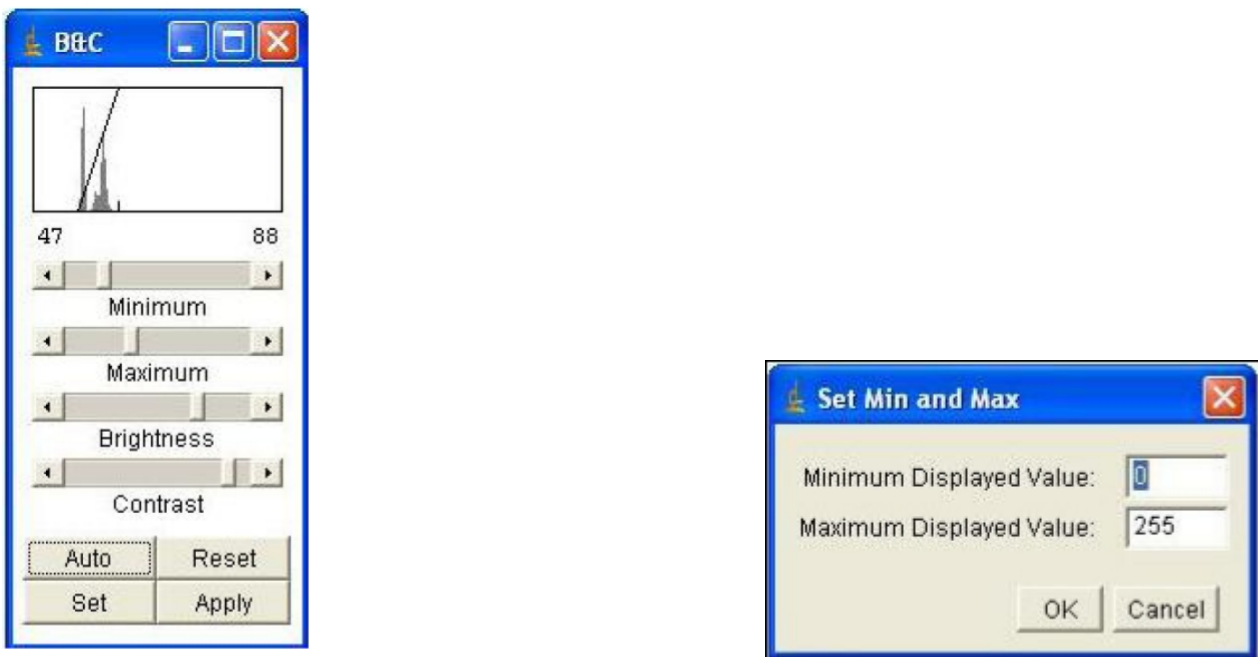
Figure 9: Principe du réglage de la luminosité et les contrastes d'une image tomographique.
