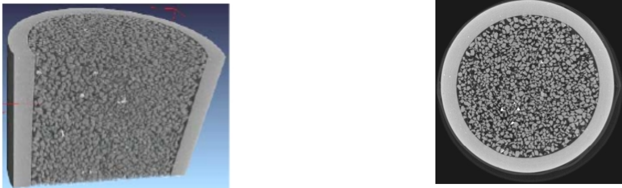
Figure V.2: Coupes tomographiques 3D et 2D d'un échantillon de sable d'Hostun fin de diamètre 10mm (diamètre moyen 0.32mm) (Lenoir, [80]).
