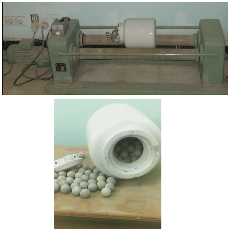
Figure III.3. Le Broyeur à boulets
