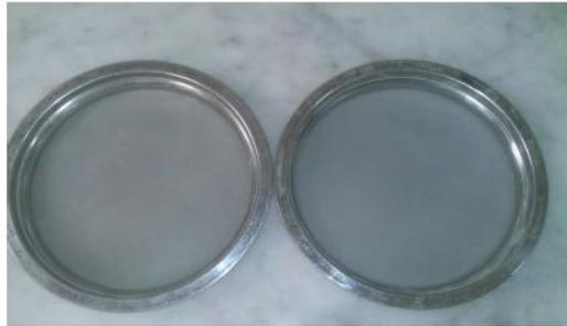
**Figure 1.8: Les tamis de 90 µm et de 45 µm.**
