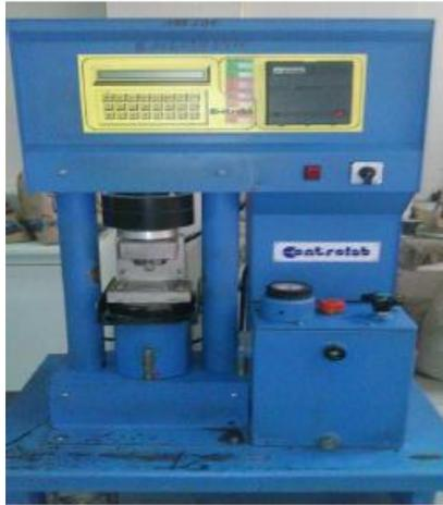
**Figure 1.19: Appareil de flexion.**
