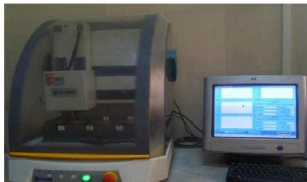
**Figure 1.13: Prisomètre automatique multipostes.**
