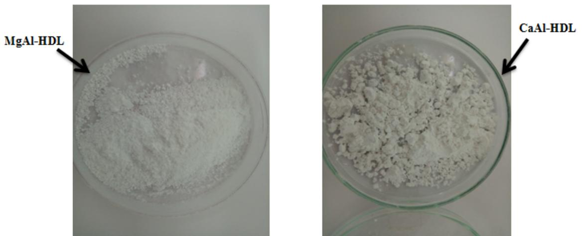
**Figure 4.3 :** Produit final après broyage de CaAl-HDL et de MgAl HDL.
