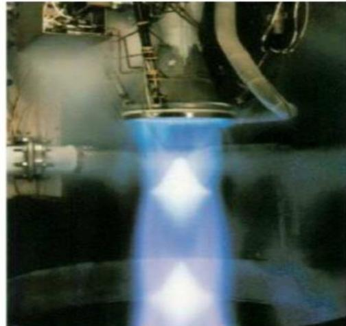
**Fig.I.30.** Réflexion régulière dans une tuyère réelle RL10-A5 [23].
