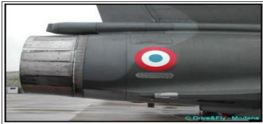
**Figure.I.12.** Tuyère à section variable [16].
