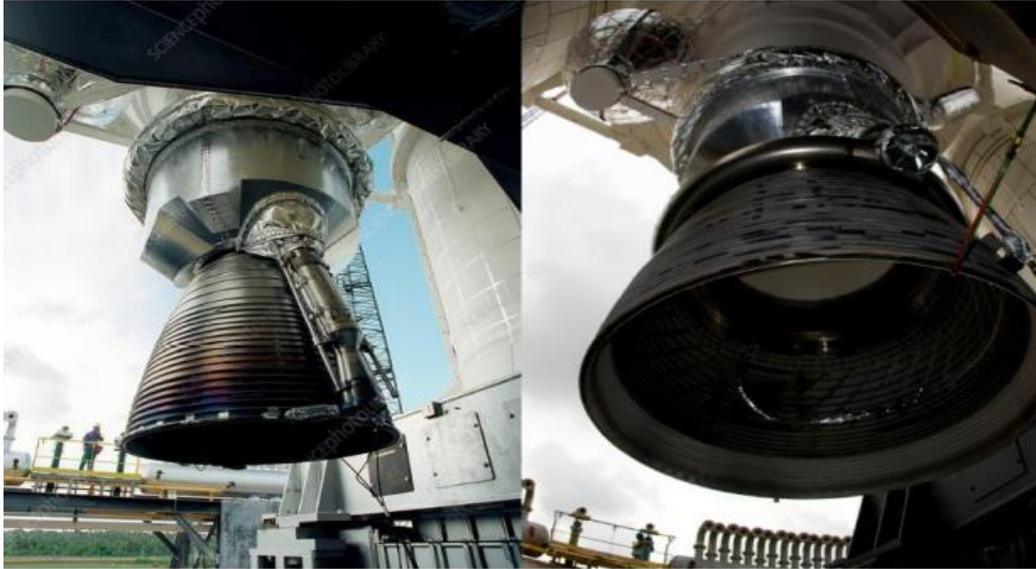
**Figure.I.5.** Tuyère du moteur Européen Vulcain2 d'Ariane5
