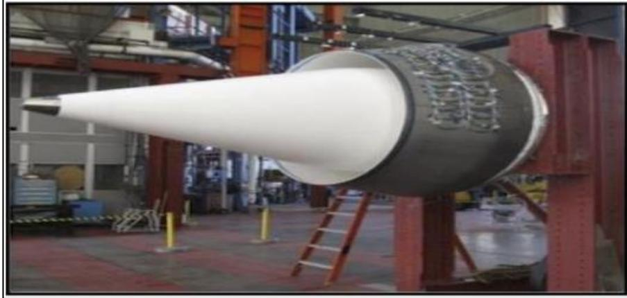
**Figure.I.11.** Tuyère à noyau centrale.
