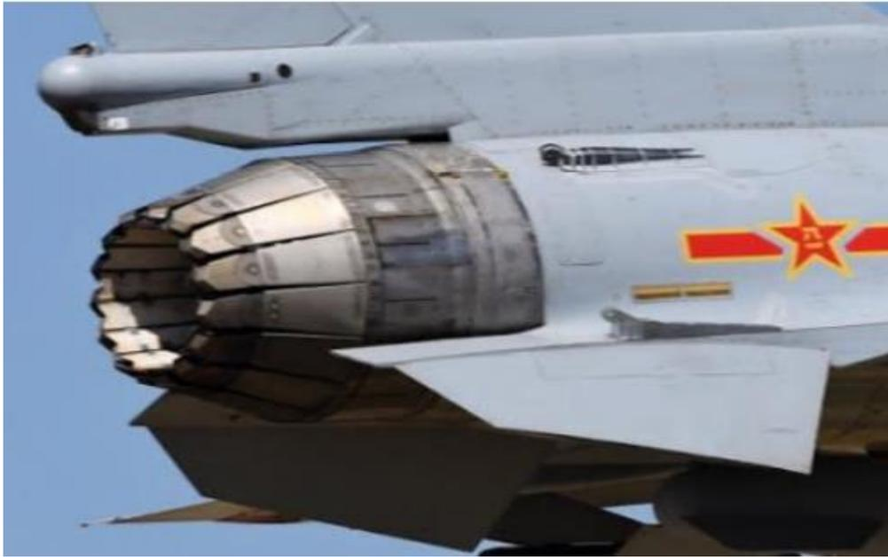
**Figure.I.6.** Tuyère d'un avion de Combat Chengdu J-10
