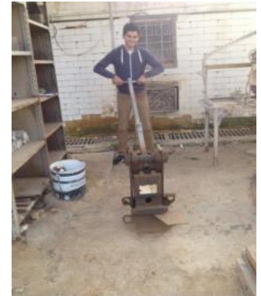
Figure 5.34: PHOTO DE LA MACHINE DE COMPRESSION DES BRIQUES DE BTS. (PAS DE NUISANCES SONORES DURANT LE CHANTIER, NI DE GASPILLAGE ENERGETIQUE). SOURCE : AUTEURS.
