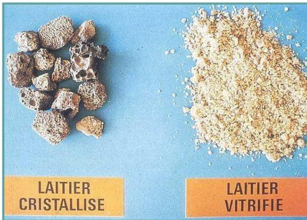
Figure I.14 : Laitier cristallisé et vitrifié.
