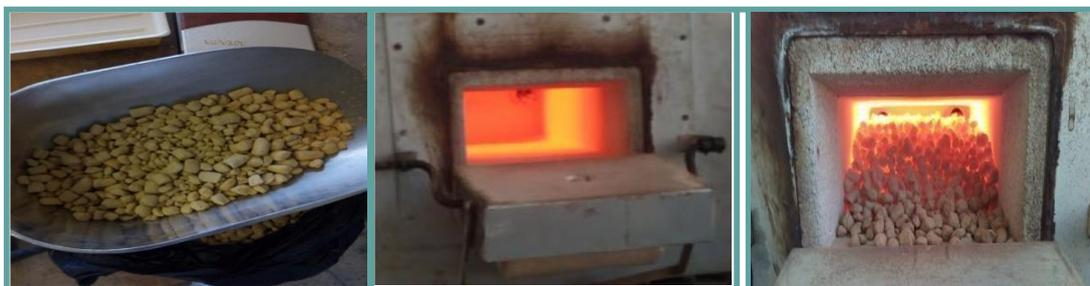
Figure I.13 : Processus de calcination flash du kaolin.
