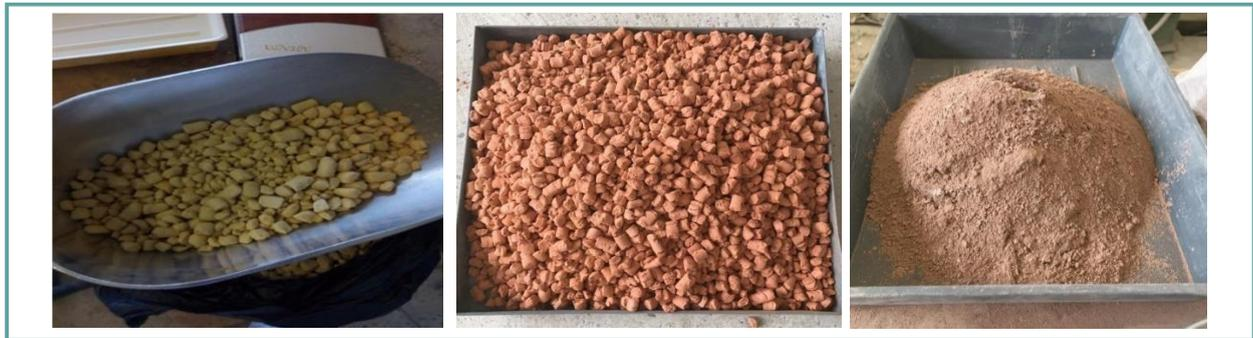
**Figure I.12 :** (a) le kaolin, (b) le métakaolin et (c) le métakaolin broyé.
