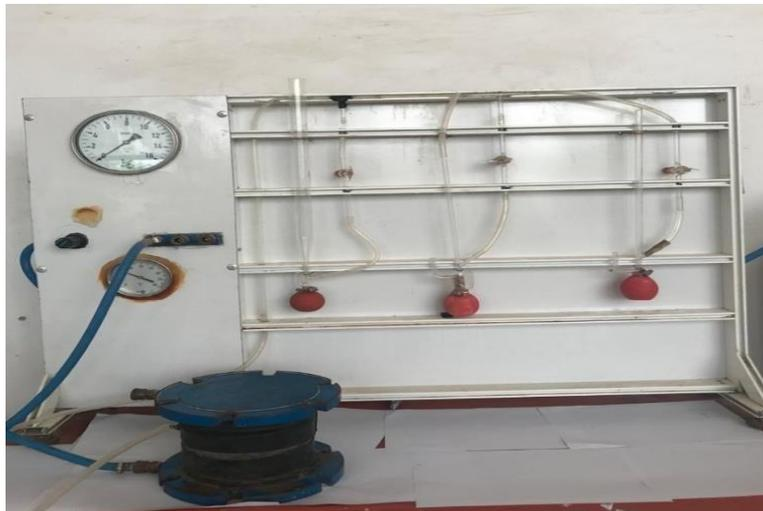
Figure II.9: matériels utilisé pour l'essai perméabilité à gaz.
