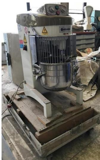
Figure II.8: Malaxeur de mortier
