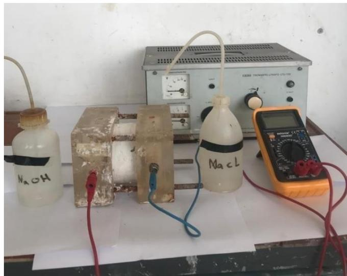
Figure II.10: Essai de la résistance à la pénétration des ions chlorures
