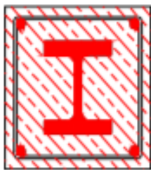
Figure 50 : Coupe sur un poteau mixte source : mémoire de magister en génie civil
