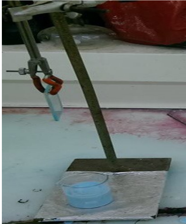
Figure 2.6. dépôt de montmorillonite + BM par la technique dip-coating.
