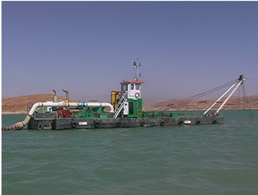
Fig. 3.14. Dragage du barrage de Foum El Gherza (ANBT)
