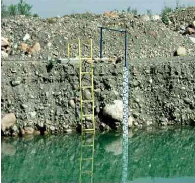
Figure 11: Echelle limnométrique au niveau d'un bassin d'infiltration
