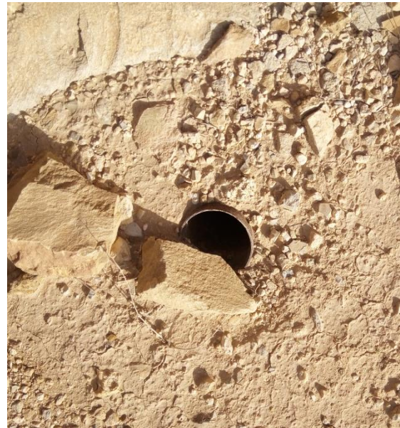
Fig. 3.13. Piézomètre obturé non utilisable (photo. Mai 2017)
