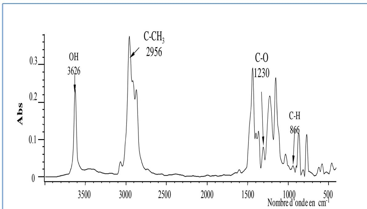
Figure IV.2. Spectre IRTF du BHT
