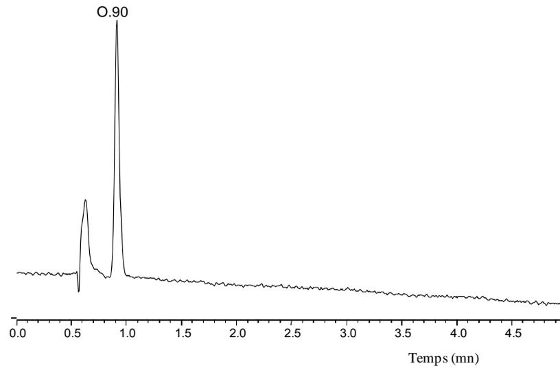
Figure IV.4. Chromatogramme du BHT dans l'éthanol à 0,033 g/L.
