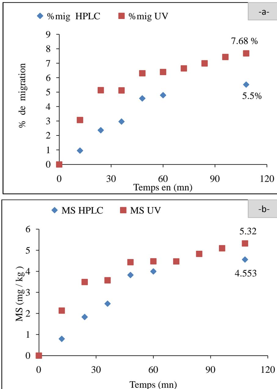
Figure IV.13. Évolution des % de migration (-a-) et de MS (-b-) du BHT dans l'éthanol à 40°C.
