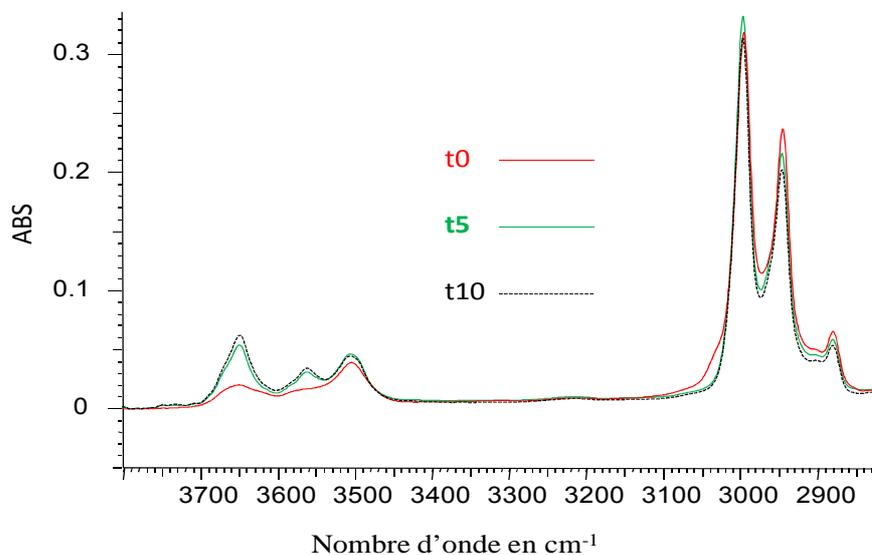
Figure IV.9. Spectres IRTF d'un film en PLA mis au contact de l'éthanol à 40°C pendant 5 et 10 jours.
