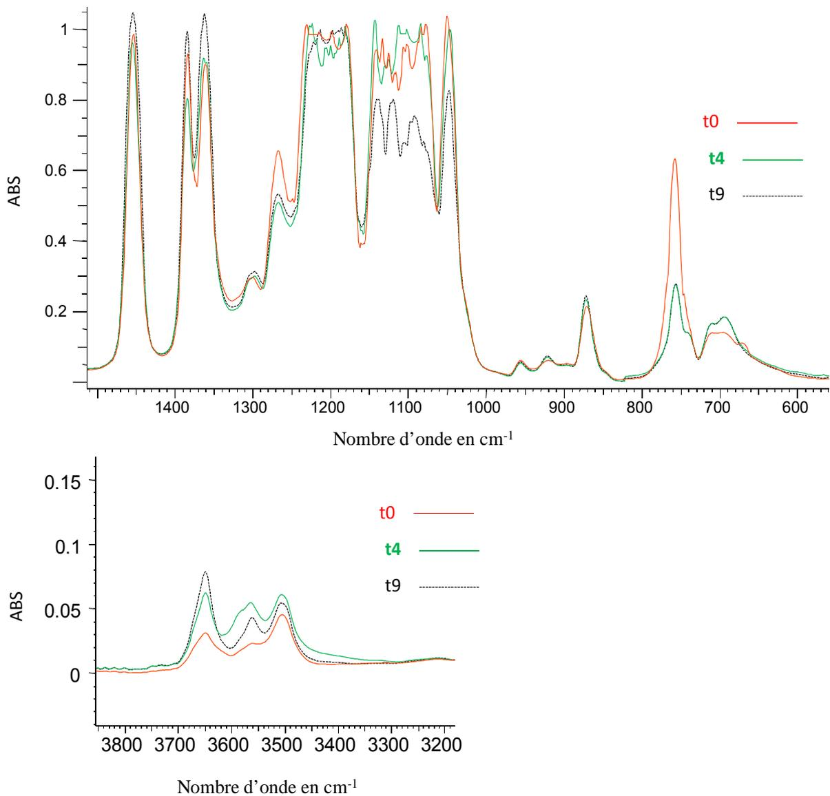
Figure IV.10. Spectres IRTF d'un film en PLA mis au contact de l'éthanol à 70°C au bout de  $t_4$  (48 mn) et  $t_9$  (108 mn).
