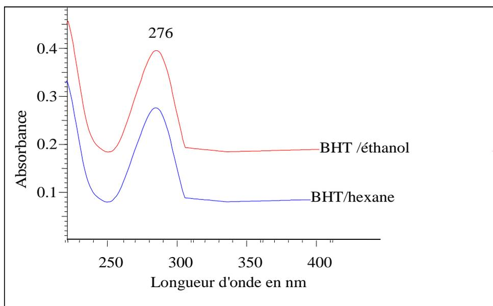
Figure IV.1. Spectres UV du BHT en solution dans l'hexane (ou l'éthanol)
