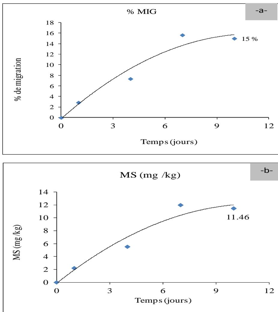
Figure IV.15. Évolution des % de migration (-a-) et de MS (-b-) du BHT dans l'hexane pendant 10 jours à 24°C
