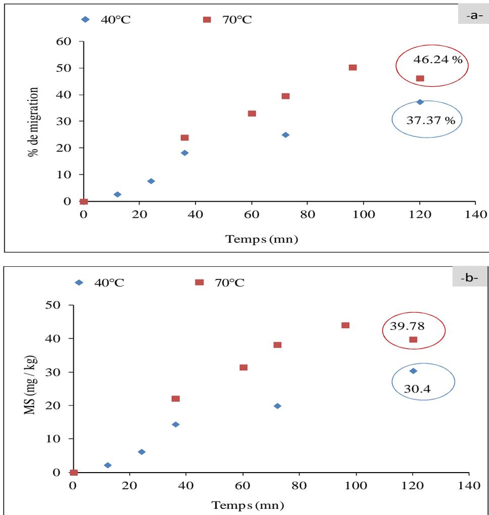
Figure IV.16. Évolution des % de migration (-a-) et de MS (-b-) du BHT dans l'hexane pendant 2 heures à 40°C et 70°C.
