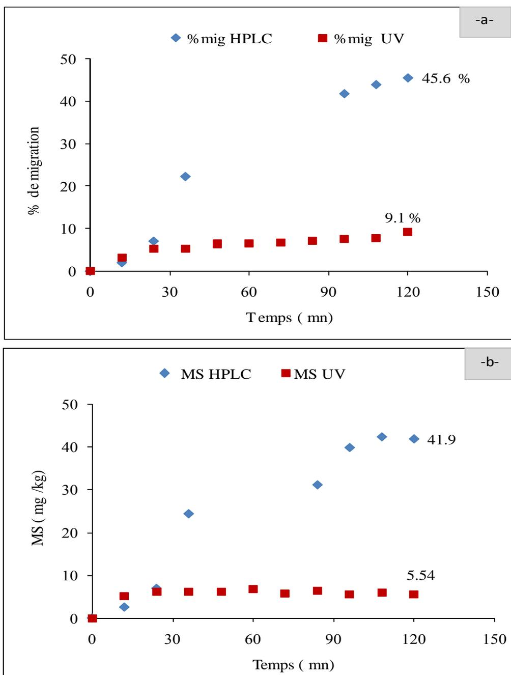
Figure IV.14. Évolution des % de migration (-a-) et de MS (-b-) du BHT dans l'éthanol à 70°C.
