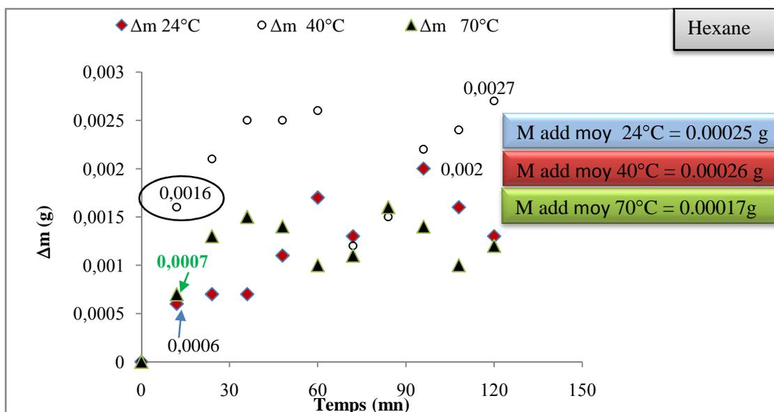
Figure IV.6. Variation de la masse des films au cours des tests de migration dans l'hexane.
