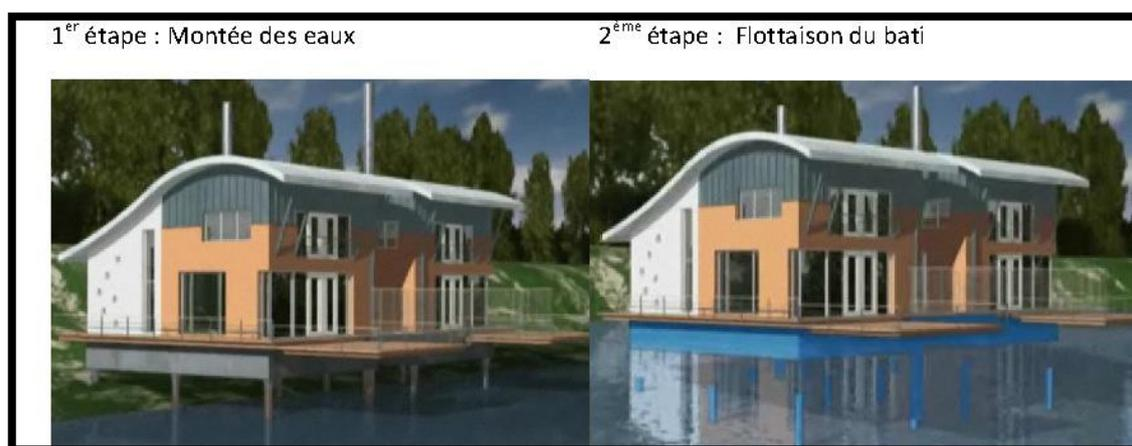
**Figure 6 chapitre II :** Mise en action du système lorsque la crue survient
