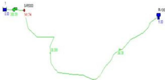
Figure V-5 profil piézométrique de l'adduction entre R5000 ET R1000 AMMAMIR
