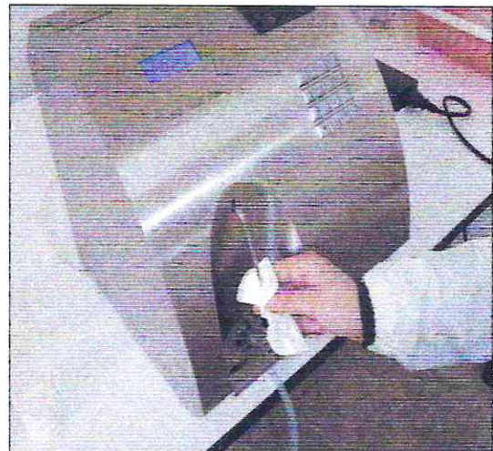
Figure12 : nettoyage de la pipe mobile.
