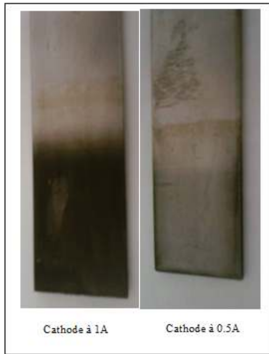
Figure V.2. Cathode après l'électrolyse avec des intensités de courant de 0.5 A et 1A.
