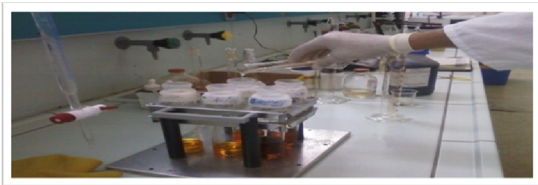
Introduire le volume V correspondant à la gamme d'estimation de la DBO5 par rapport à la DCO du même échantillon dans un flacon brun en verre contenant un barreau magnétique.
