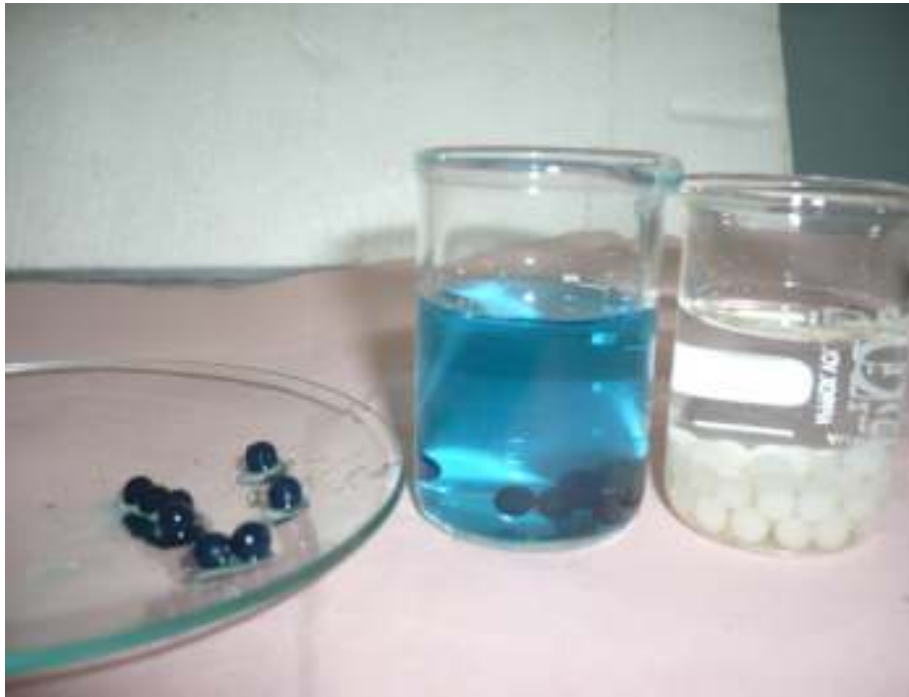
Figure 3.10: Photographies numériques des billes gélifiées CIME-Al/PVA. (à droite): avant adsorption du VM ; (à gauche) : après adsorption
