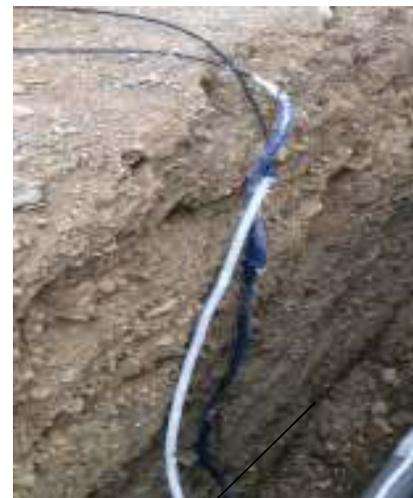
fig.III.5.emplacement des thermocouples
