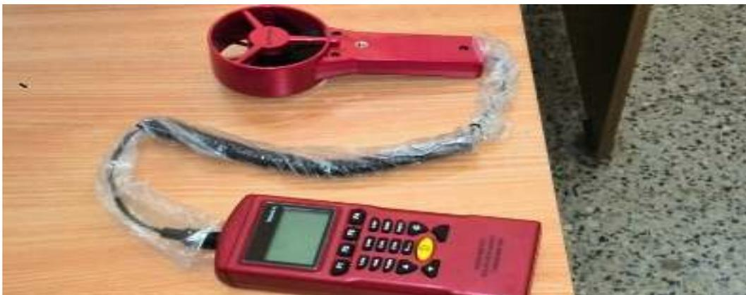
fig.III.3. anémomètre à hélice
