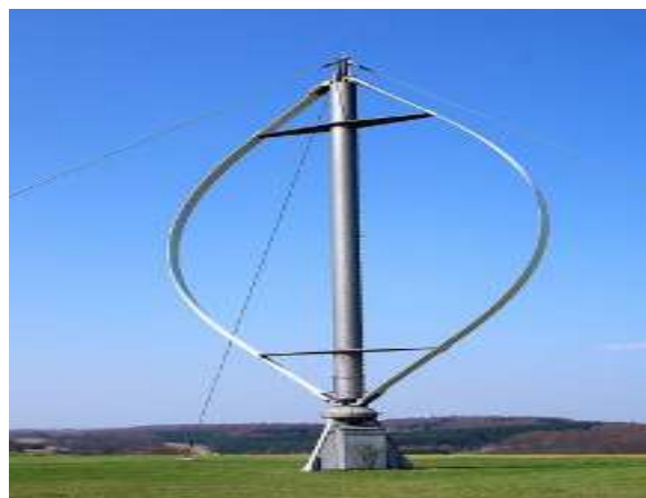
Figure 1.4 : Éolienne de Darrieus
