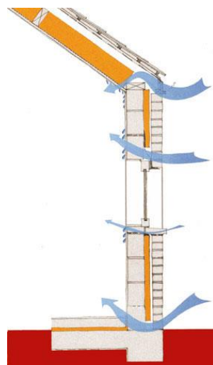
Figure 1.9 : Zones à ponts thermiques.[20]
