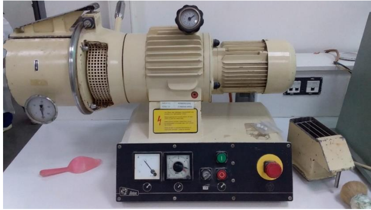
Figure 20 : Mélangeur granulateur LODIGE
