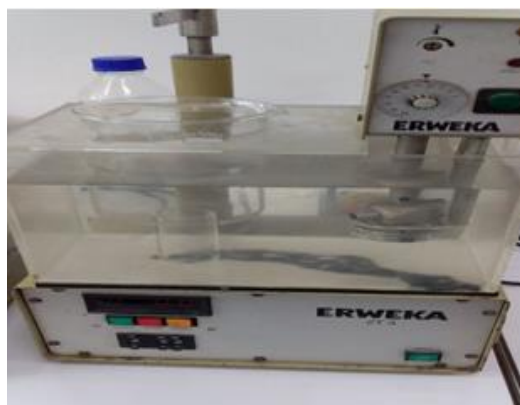
Figure 28 : Appareil de délitement : ERWEKA ZT3
