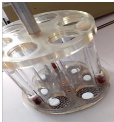
Figure 33 : 6 comprimés placés dans les tubes de l'appareil de désagrégation
