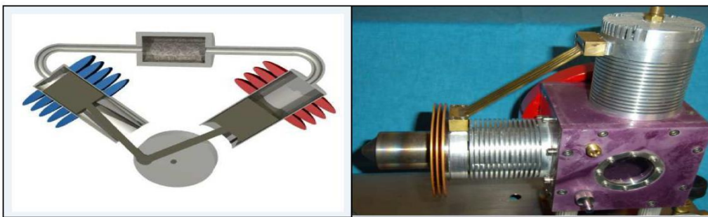
Figure 1.10 : moteur Stirling de configuration alpha (Article de bonneet, S (2005))
