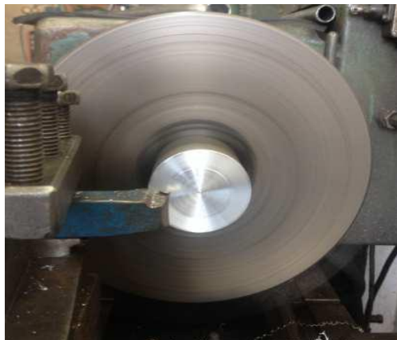
Figure 3.4 : la fabrication du radiateur
