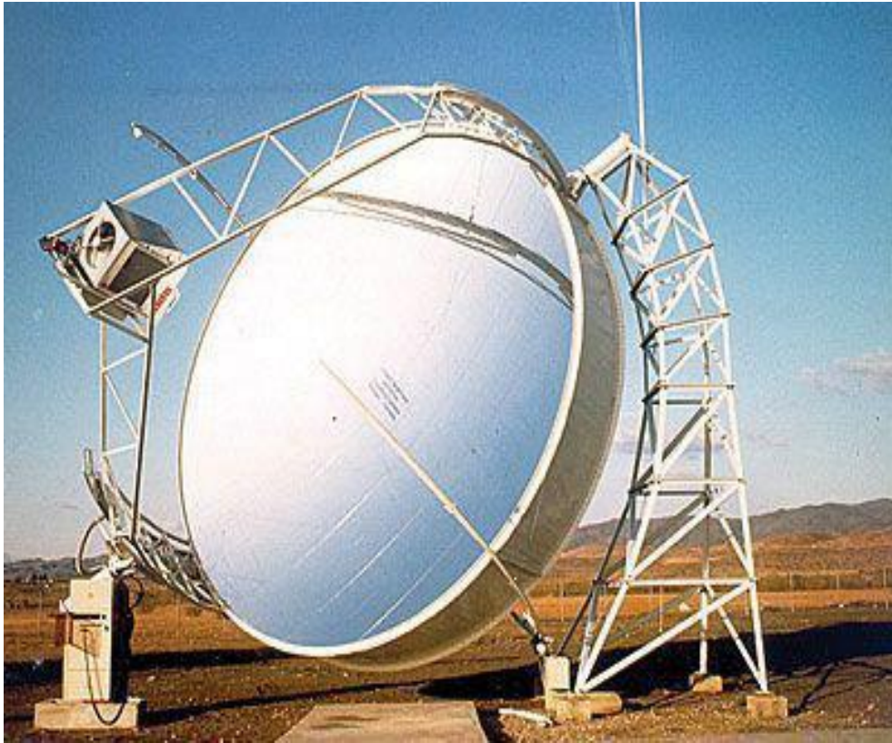
Figure 1.2: Capteur parabolique avec moteur Stirling
