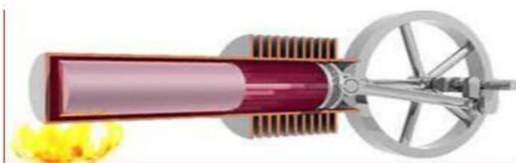
Figure 1.11 : Moteur Stirling de configuration beta (Article de Bonnetts, S (2005))
