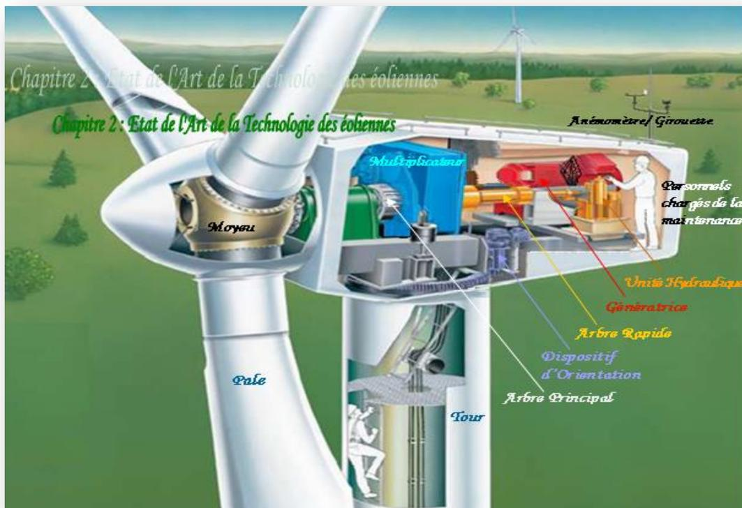
Figure 1.6 – Composants principaux d'une éolienne [59].
