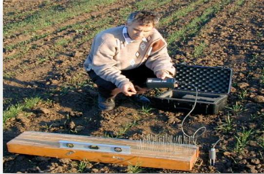
**Figure 2.2 – Mesure de la rugosité du sol.**
