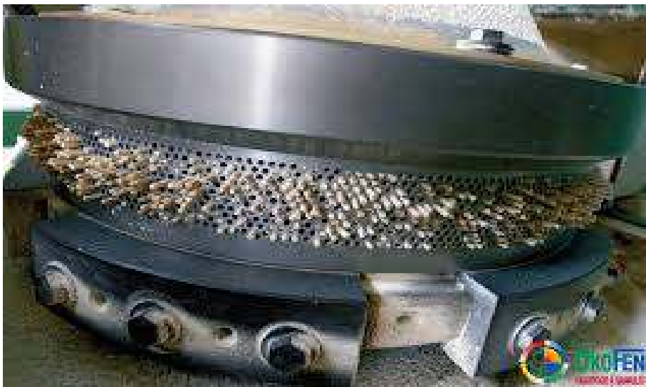
Figure (3.4) : Vue des granules après extrusion et avant sectionnement
