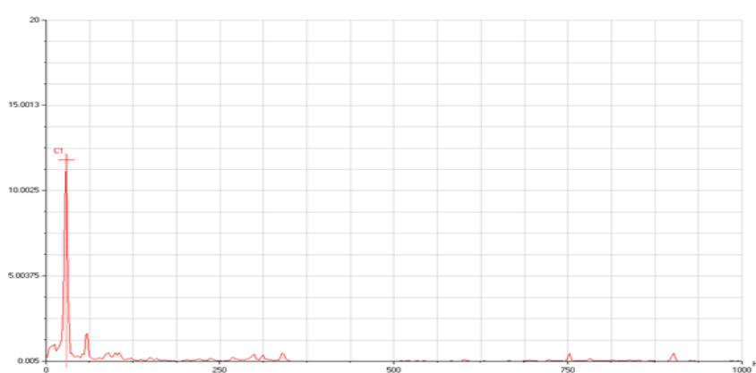
Figure 2-8 Spectre réel d'un moteur tournant à 1485tr/mn (30 Hz) traduisant la présence d'un balourd
