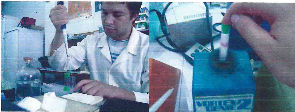
Photo 20 : De gauche à droite ; reconstitution de la suspension et agitation pour homogénéiser
