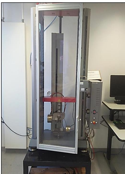
Figure 2.2 : Photographie de la machine de traction utilisée (Zwick/Roell Z10).
