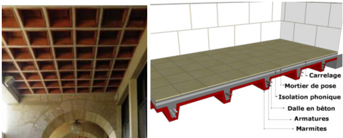
Figure 1. 10: Les caissons en terre cuite du Vieux Port de Marseille conçu par Jean Amado et fabriqué par la SGTM [41].
