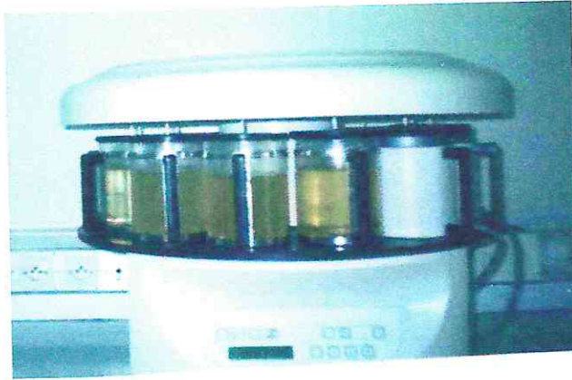
Fig 17: appareil à circulation LIECA TP 1020
