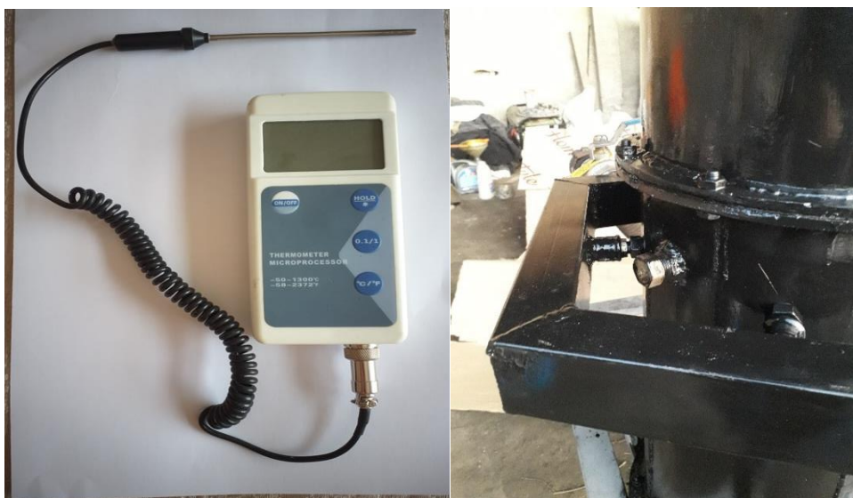
Figure 4.9 A gauche Thermomètre PT 100 à type K, à droite point de mesure dans la zone de réduction
