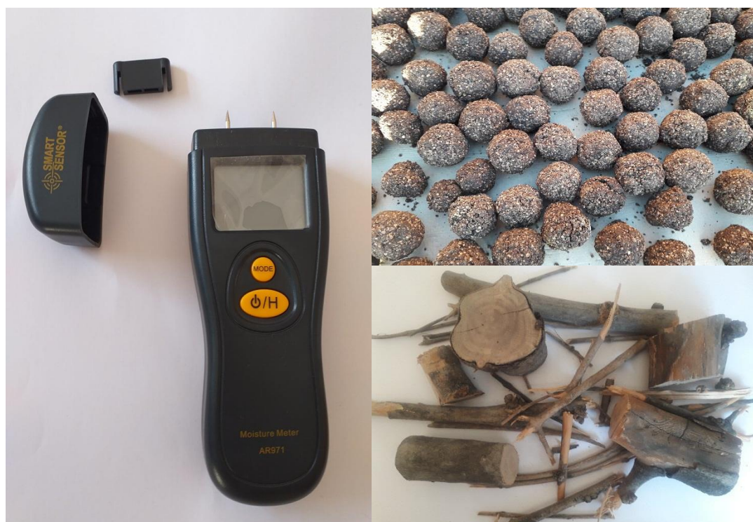
Figure 4.10 Hygromètre pour la mesure de la teneur en humidité dans le combustible.
