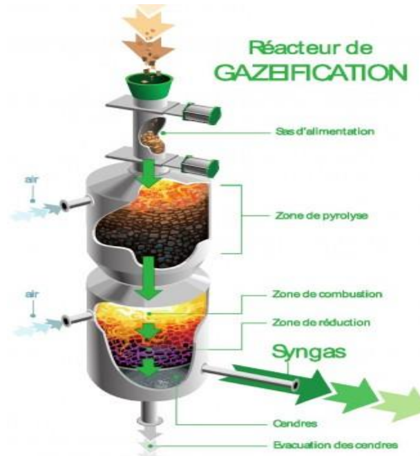
Figure 1.21 Procédé de gazéification à lit étagée Nota Centrale Syncraft werk CW 700 (Autriche)
