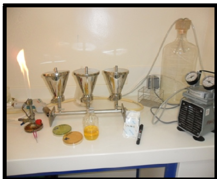
Rampe de filtration
