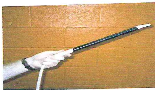
Photo 14 : Une sonde avec un tube de guidage (NEAL et al, 1993).
