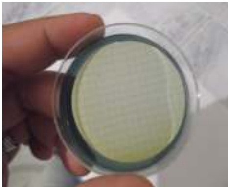
Figure 19. lecture après 24 h d'incubation pour l'eau filtrée apres l'injection des ferrates
