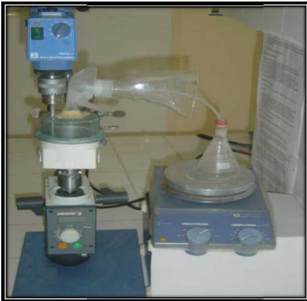
Figure II.3 : Schéma du mélangeur-granulateur conçu [2].
