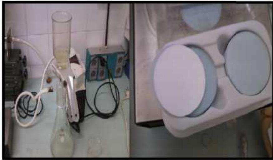
Figure III.4. Dispositif de la filtration
