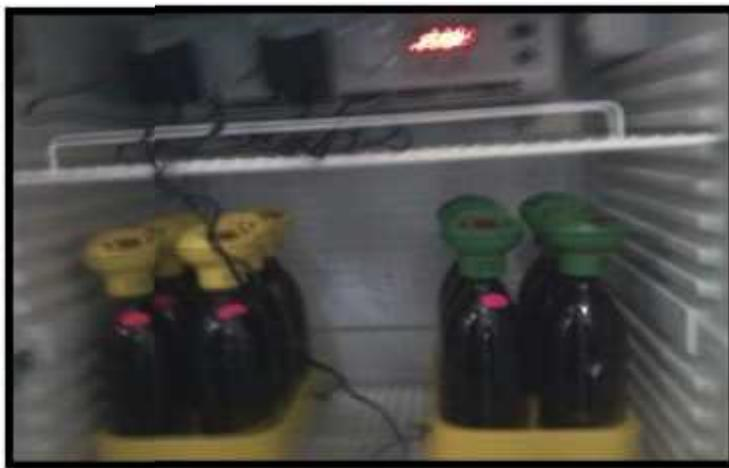
Figure III.7. Mesure de la  $DBO_5$
