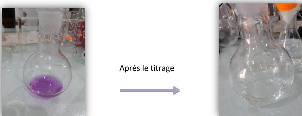
**Figure III.12:** Estérification de la solution huileuse et solution de blanc par dosage.
