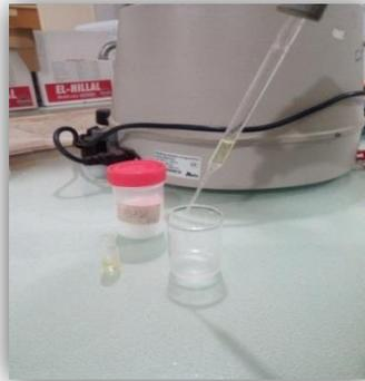
**Figure III.7:** L'huile récupérée est séchée par du sulfate de magnésium.
