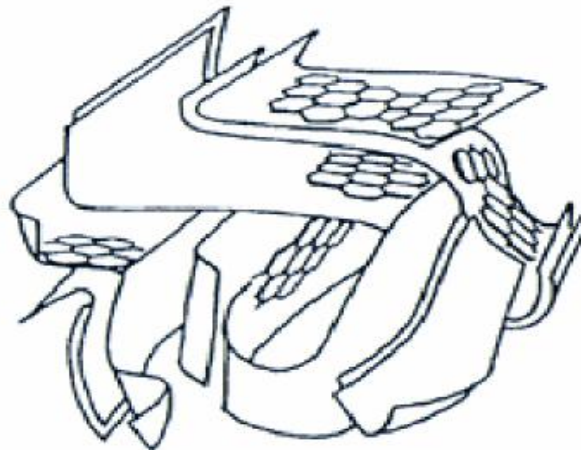
Figure I.2 : Représentation schématique des microstructures du charbon actif [9]
