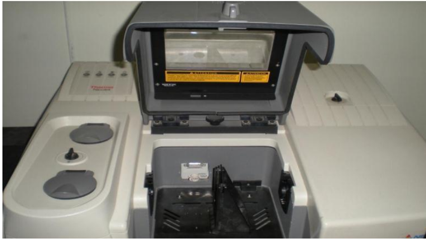
Figure 16 : Spectromètre Infrarouge à Transformée de Fourier.
