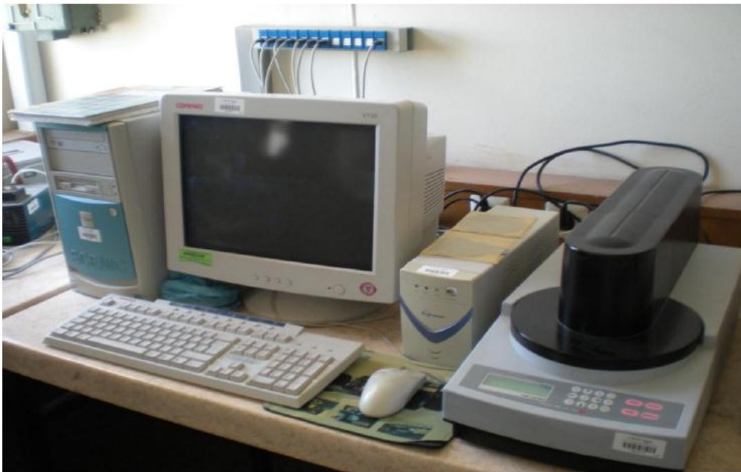
Figure 18: Dispositif de mesure de la résistivité
