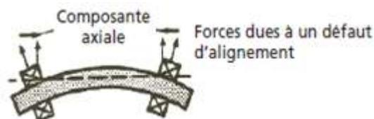
**Figure II.6 Flexion d'arbre due à un défaut d'alignement ou de concentricité des paliers**
