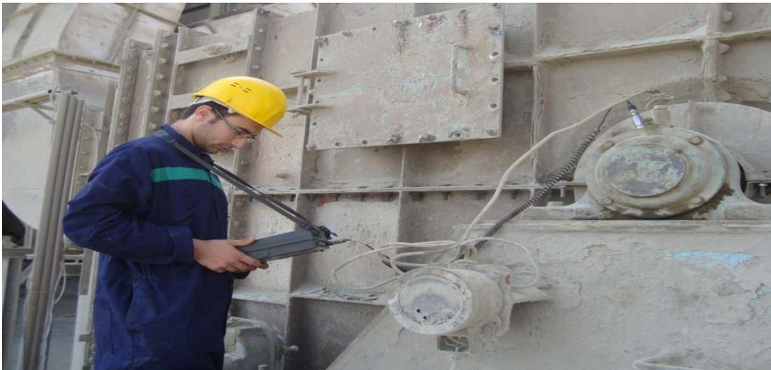
**Photo III.4** : Ventilateur EXHAURE CIMENT côté palier libre.
