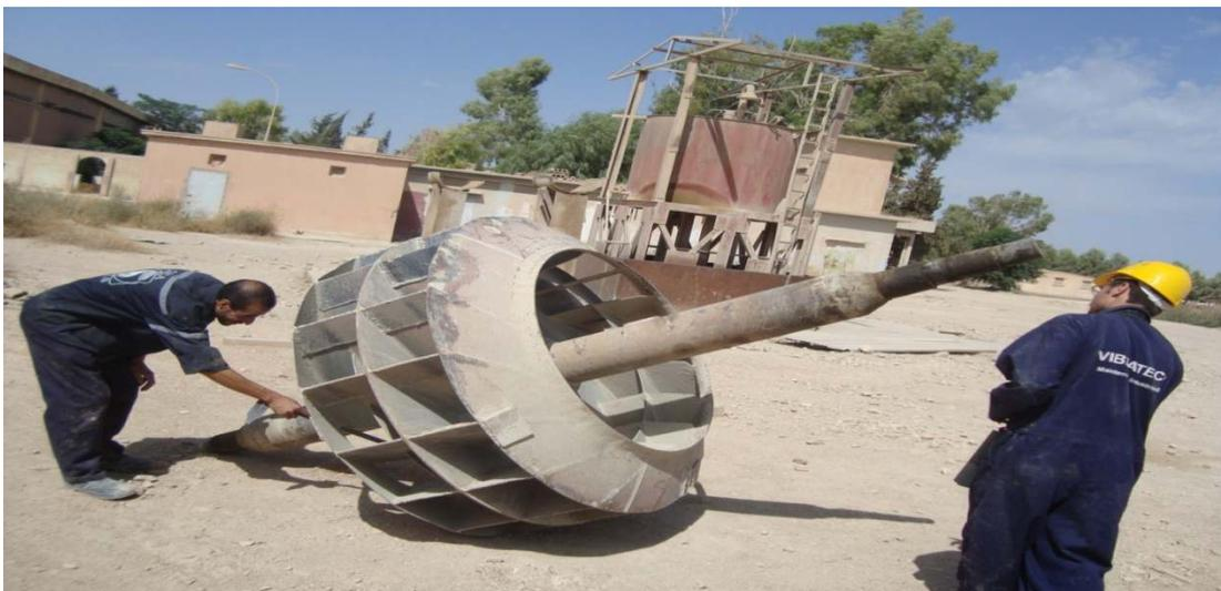
**Photo III.5** : Turbine du ventilateur EXHAURE CIMENT.
