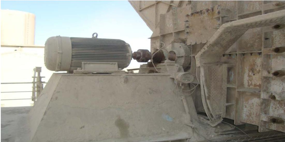
**Photo III.3** : Ventilateur EXHAURE CIMENT côté moteur.
