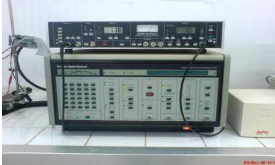
Fig 3.4. Photo du potentiostat/gavanostat EG&G (PAR 273A), en dessous, et de l'analyseur de fréquence EG&G (type 5210), en dessus.
