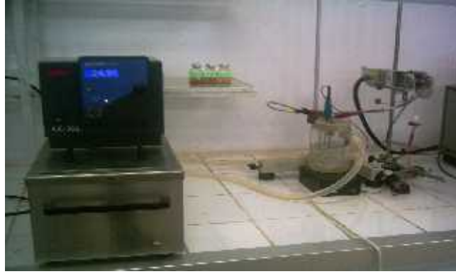
Fig 3.2. Photo du cellule électrochimique (à droite) et du bain thermostatée(à gauche)
