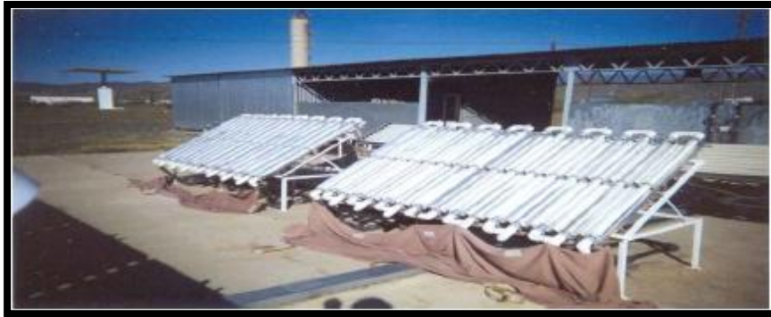
Figure (1.16): Pilote solaire (Photoréacteur à collecteur compose parabolique) utilisant des suspensions sur la plateforme permettant de dépolluer 300 litres d'eau par jour
