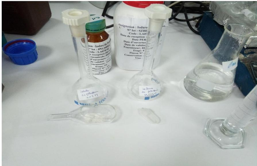
Figure 11:préparation des deux réactifs l'iodate de potassium et l'iodure de potassium
