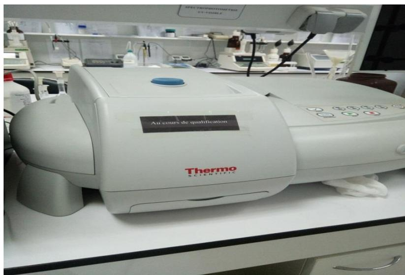
**Figure 10: UV-visible utilisé dans le dosage d'iode**
