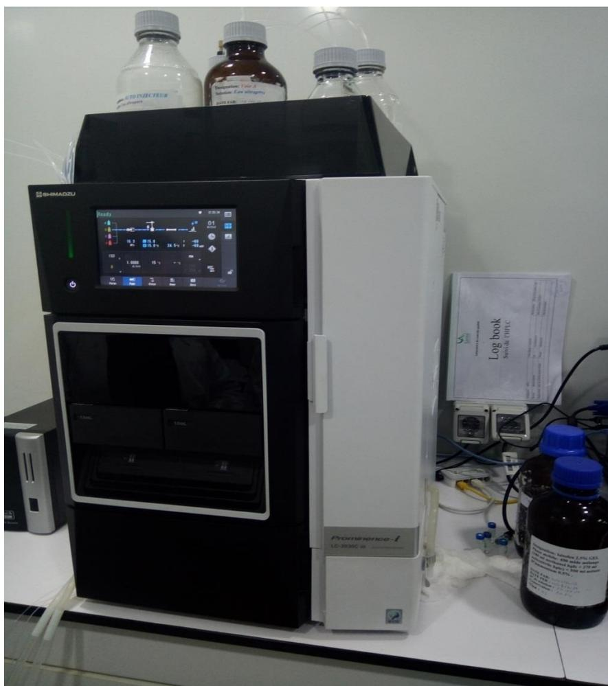
**Figure 16: HPLC utilisée dans le dosage de 4-Aminophénol**
