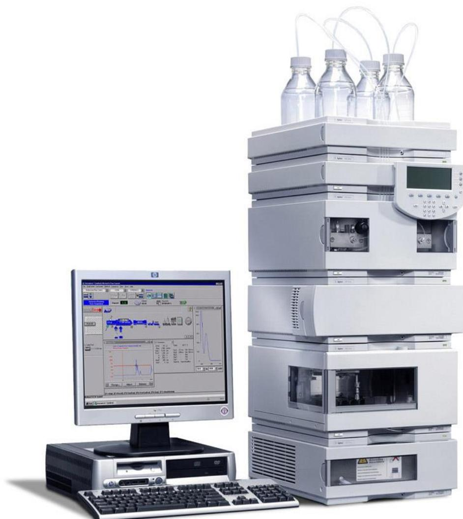
**Figure 5 : chromatographie liquide haute performance HPLC**
