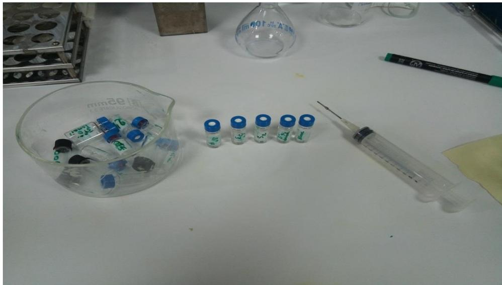
**Figure 21 : remplissage des cuvettes de HPLC**
