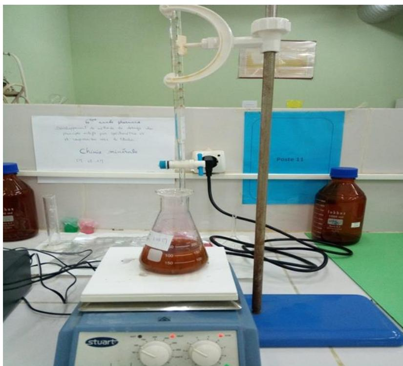
Figure 35: titrage d'ion ferrique par le thiosulfate de sodium.
