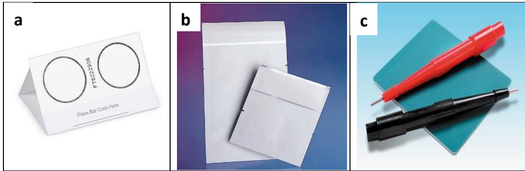
Figure 12 : a. Mini-cadre FTA. b. Pochette de stockage pour la protection des cartes FTA® contre les gaz ou les liquides. c. Tapis de coupe et micro-poinçonneuse.
