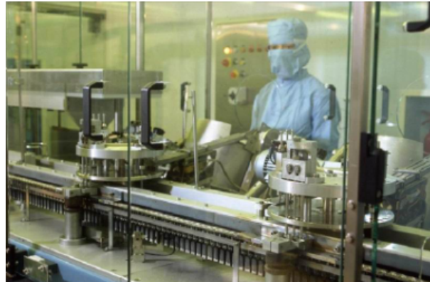
Figure IV.9 – Opération de remplissage.
